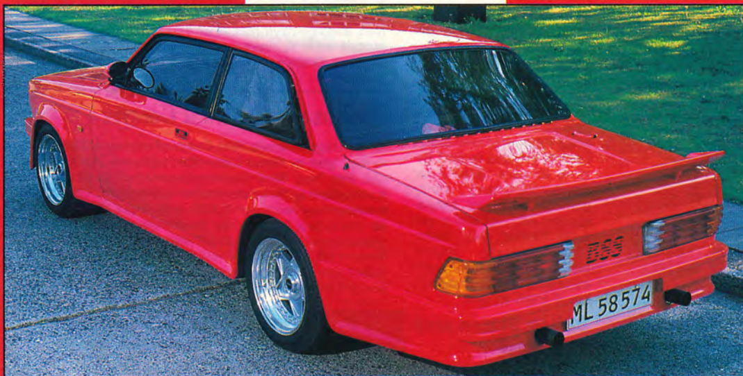
Rena linjer var ett krav då Bjarne började med plåtarbetet. Dock gjorde han ett avsteg och monterade en grupp-A ving av plast på den smäckert ombyggda bakluckan. Observera tanklockets placering, det ligger nedsänkt i bakluckans högra del.
