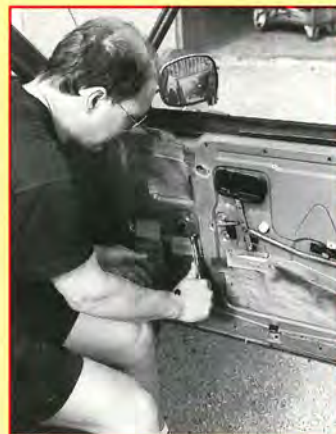
2. Eftersom dörrutorna inte skall användas och dessutom inte går att veva ned helt tas de bort. Även tätningsslisterna i dörrarna avlägsnas!
