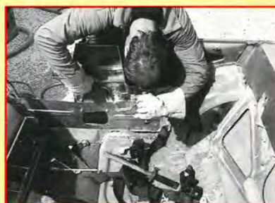
12. Yttre tröskelplåten får inte plats inne i väggpartiet bakom dörren, men där förstyvas istället den längre plåten ett fyrkantssör som löper från dörrstolpen till bakre hjulhuset.
