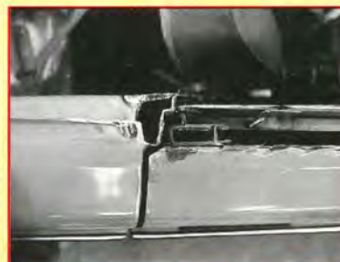
12. Yttre tröskelplåten får inte plats inne i väggpartiet bakom dörren, men där förstyvas istället den längre plåten ett fyrkantssör som löper från dörrstolpen till bakre hjulhuset.
