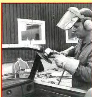
14. Vindruteramen stängs igen med en plåt på insidan. Här kräver Bilprovningen att inga vassa kanter får förekomma. Därför låter vi dörröppningens befintliga skyddslist nu gå vidare upp över fönsterbågens nedre kant.
