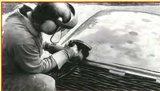
7. För att vindruteramen skall bli välproportionerlig bör överdelen vara lika tjock som sidostolparna. Här är det dubbla plåtar på ett par centimeters avstånd från varandra som skall skäras av!
