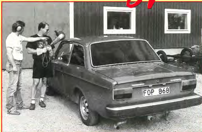
1. En 1974 års Volvo 142 för omkring 3.000 kronor är ett perfekt ämne för en takkapning. För de slantarna är det svårt att få en bil som både är perfekt i lacken och dessutom rostfri. Det senare är det viktigaste när taket skall kapas av och det var fallet med vår bil.
