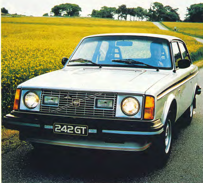
▲ 1978 sportade Volvo till programmet genom att introducera 242 GT med 123-hästarmotor, inbyggda dimljus i grillen, 20-ekrade lättmetallfälgar och styvare fjädring.
