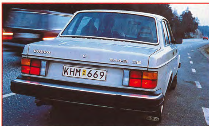
Volvo 244 GL D6 var ett försök att slå sig in på dieselmärkningen. Motorn hämtade man från Volkswagen och var en rak sexa som gav 82 hk. Premiär 1979.
