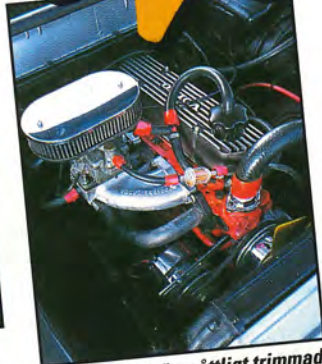
DRIFTSÄKER. B20-motorn är måttligt trimmad. Innerskärmarna är klädda med lackerade plåtar för ett renare helhetsutseende.
