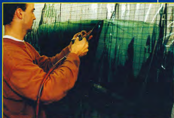
LACKA. Den amerikanska specialfärgen för glas-toning flödas på rutans insida med ett rörmunstycke och får sedan rinna lodrätt till ett jämntjockt lager.
