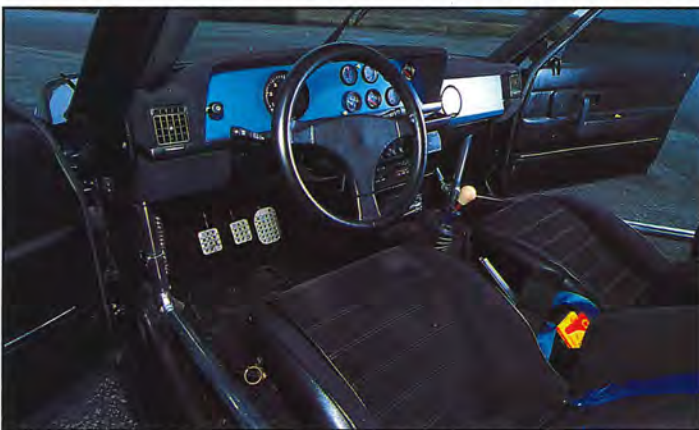
VARVET VIKTIGAST. Panelen är försedd med en Porsche-varvräknare, placerad i centrum. Hastighetsmätaren är förflyttad till passagerarsidan! Aluminium-buren är äkta vara. Anpassad för grupp A. Peter fick tag på den genom Steffanssons.
