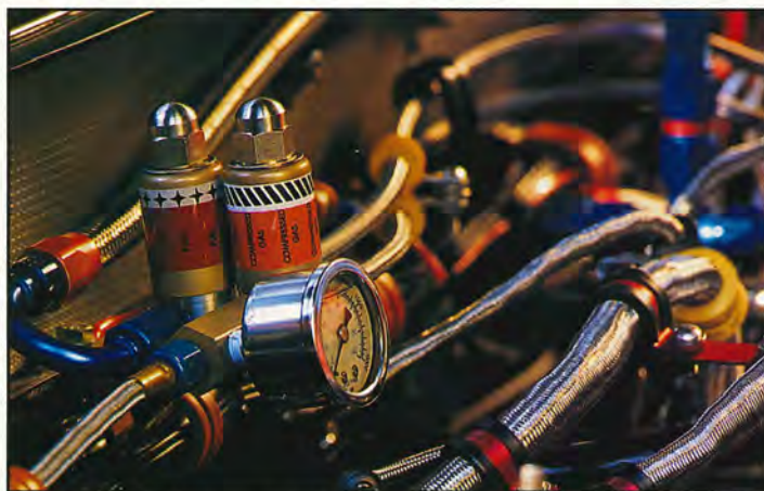
GRYM FINISH. Den som lyfter på huven blir rikligt belönad. Finishen är helt outstanding och man förstår att Bob jobbar i flyplansindustrin. Upplägget är klart inspirerat av detta. Notera de stålomspunna kabelhävorna!
