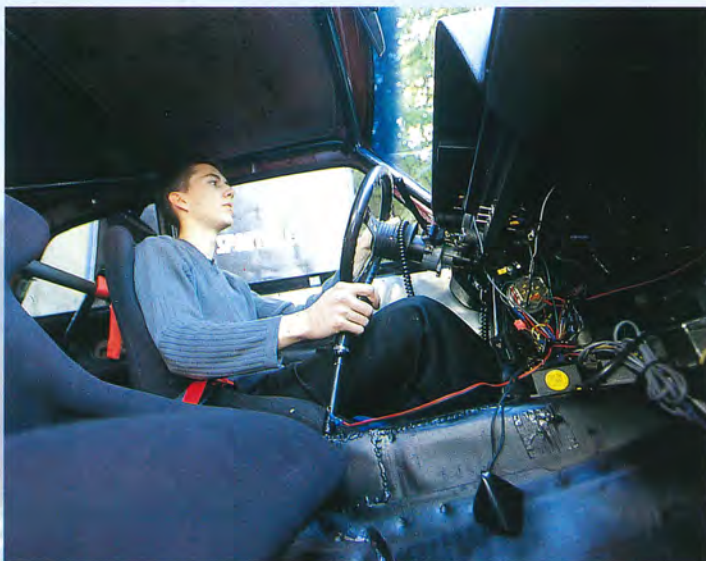
FÖR SÄKERHETS SKULL. En rallybur från Guss ger stadga åt chassit och nödvändig säkerhet om olyckan skulle vara framme. Bra passform och lätt tonade rutor gör att den inte syns allt för mycket utifrån.
