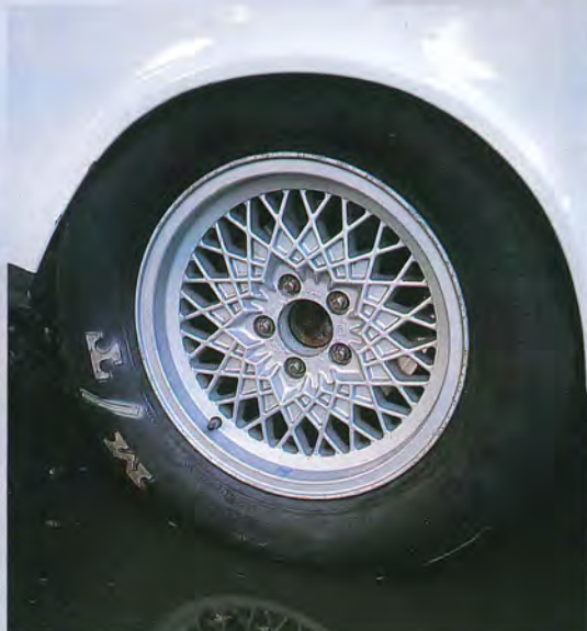
KUGGHJUL. Under sitt tidigare liv sladdade TTR runt med vinterdäck på bilen. Spjuvern har satsat på riktiga klisterpåsar. Mickey Thompson ET Street är inte bara mönstrade och gatgodkända — de biter tag i backen som kuggstäng. Efter modifiering av bakvagnen greppar bilen nästan lika bra på gatan som på en klistrad stripp.
