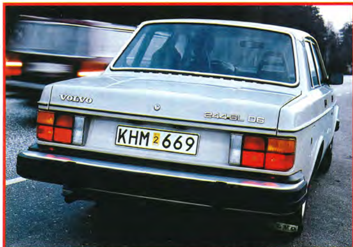
VW-VOLVO. Man kan faktiskt hitta en och annan 240 med dieselmotor. I det här fallet kommer den 6-cylindriga oljebrännaren från Volkswagen och lämnar 82 hk. Inget att rekommendera för prestandafolket.
