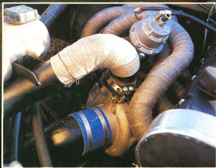
TRYCKERIET. Holset HX50 är ett manligt aggregat, wastegaten har okänt ursprung men har hår på bröstet den också.
