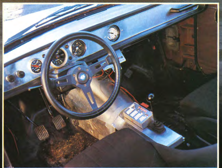
LADDRYCK I CENTRUM. I mitten av aluminiumpanelen tronar en riktig laddtrycksmätare. Inget neontjafs, bara äkta tryck.
