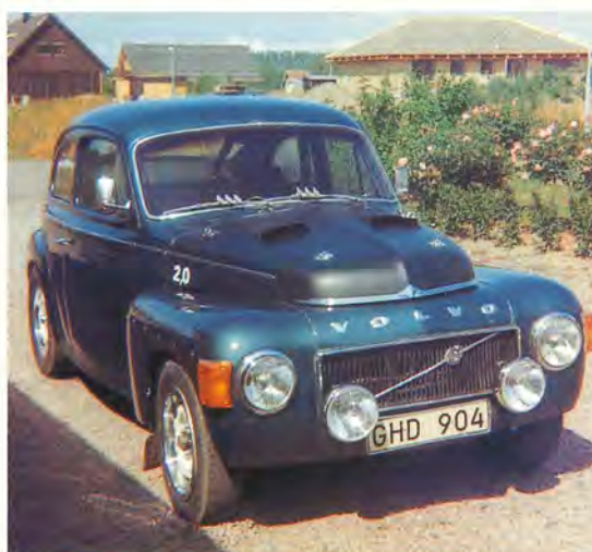
Bengt Wilhelmsson var tidigt ute. Här är PV:n i första utförandet. Lätt höjd i fronten, blinkers från 142 GL, mattsvart huv med scoop och liten markering om motorns cylindervolym.
