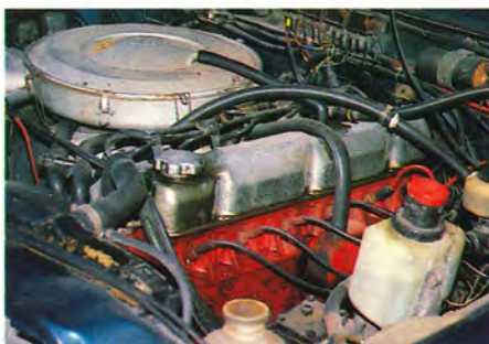
Motorn i 164:an är på 2978 cc och 130 hk.
