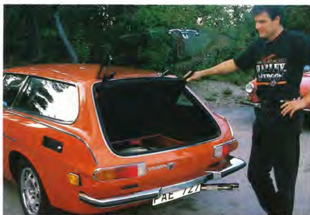
Handtag och gångjärn är fästa direkt i glaset.
