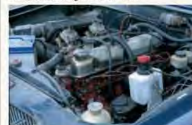
Motorn är en B30 som i sin tur innebär en förlängd B20. Trots det enkla ursprunget bjuder sexan på en tyst och civiliserad kraft med djupt register.
