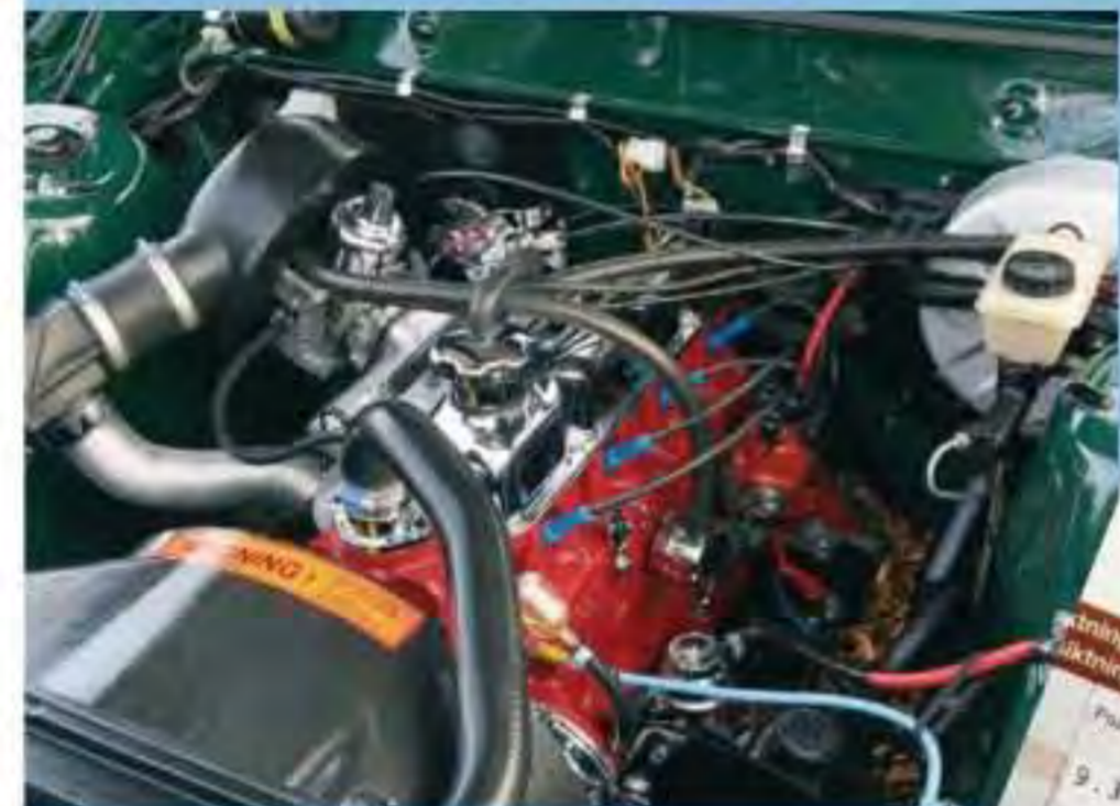
Tommys bil är en av relativt få DL som utrustades med B20-motorn, de flesta köparna ville hellre ha nya B21. Notera putsen i motorrummet, här kan man känna runt med vita handskar utan att bli smutsig.
