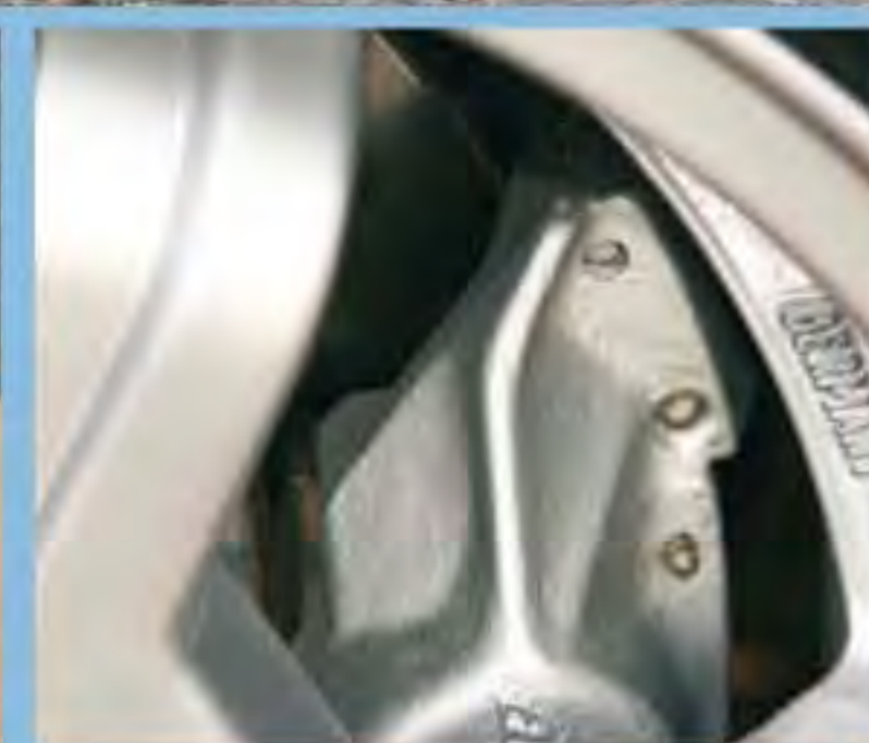
Trots att de ser nya ut är både skivor och bromsok original och alltså drygt 30 år gamla.
