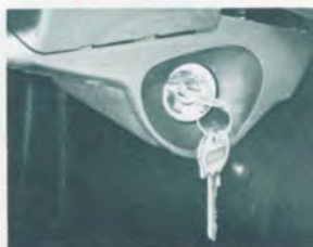
Tändningsnyckeln sitter infälld i rattstängskåpan.
