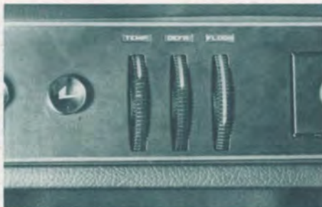
Inställning av värme, defroster och golvvärme sköts med tre rullreglage. Ju mer man ser av pilarna, ju större »pådrag».
