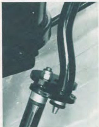
Rattstängens konstruktion är gjord så att rödelarna skjuts förbi varandra vid kollision. Hur de är fästa vid varandra framgår av bilden.
