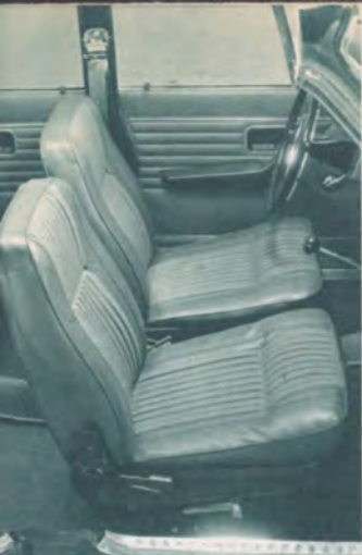
Volvo 144 har separata framstolar med steglöst variabel lutning på ryggstöden. I stolarna finns inbyggda fästen för nackstöd. Samma sak gäller baksätets ryggstöd.
