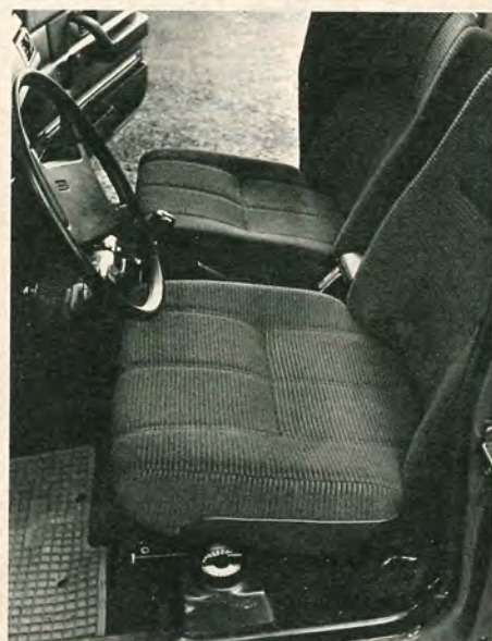
Volvo är ett strå vassare tack vare något hårdare stolsfjädring och ställbart svankstöd. I båda vagnarna är förarstolen ställbar i höjdlid.
