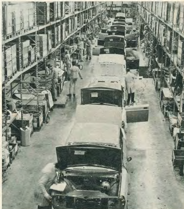
För slutmonteringen har Volvo i Gent två parallella monteringsbanor, som avslutas med provkörningsstationer och slutligen har man en nybyggd provbana utomhus för kontroll av de färdiga Volvobilarna.
