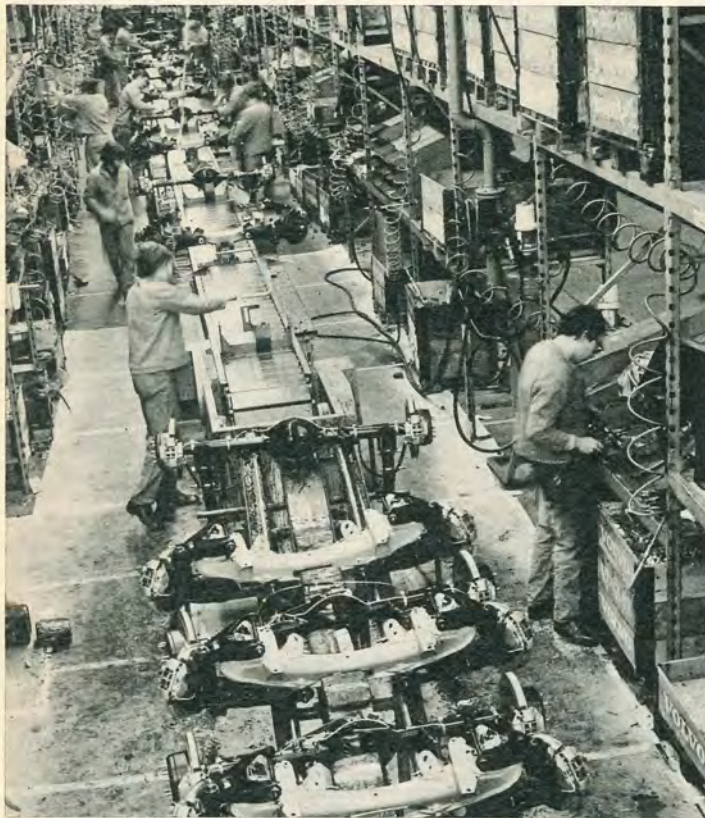
Vid förmonteringsbanor färdigställs komponenterna till bilen. Här är det hjulaxlar som monteras.
