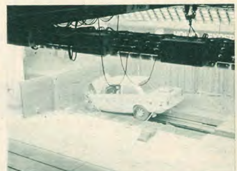
Här krockar en Volvo 142 i 80 km mot betongbarriären. Efter smällen är passagerarutrymmet fortfarande intakt. En dörr kunde öppnas, den andra försköts men gick inte upp. I trafiken skulle krockkrafterna mot barriären motsvarat betydligt högre hastigheter.
