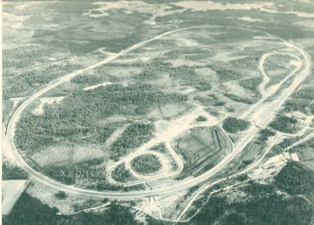
Volvos provbana i Hällered för 46 miljoner kronor visar det komplicerade system som behövs för en avancerad produktprovning. Högfartsbanan runt om är 6,3 km lång och anläggningen sysselsätter ett fyrtiotal man, åtskilliga med bevakning av banan. Ytan är 700 hektar eller 1 400 tunnland.
