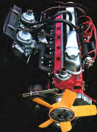
Volvos B30-motor togs fram för 164-modellen sedan planerna på en V8 stoppats. 145 hk med förgasare, 175 hk med insprutning.
