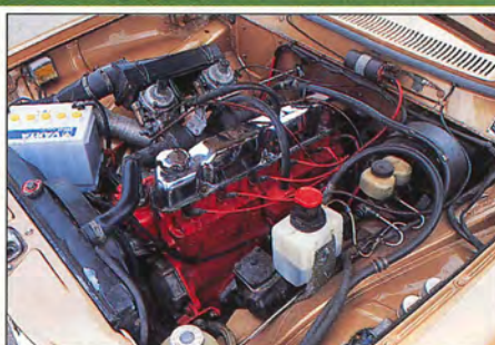
Sechs Zylinder, drei Liter Hubraum: In dieser Form leistete das Triebwerk gutmütige 130 PS.
