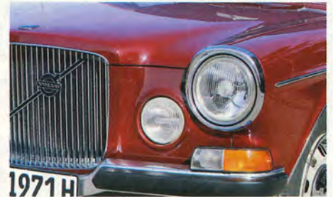
Stoßstangen und Blinkergläser wurden in mühsamer Kleinarbeit geschliffen und poliert
