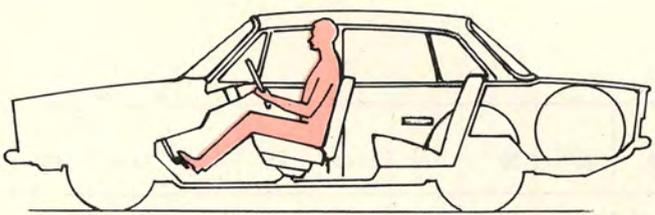
Minime condizioni di peso in esercizio: vettura parzialmente rifornita (metà serbatoio carburante) e solo guidatore: kg. 1230 dei quali kg. 640 (52 %) all'avantreno e kg. 590 (48 %) al retrotreno.
