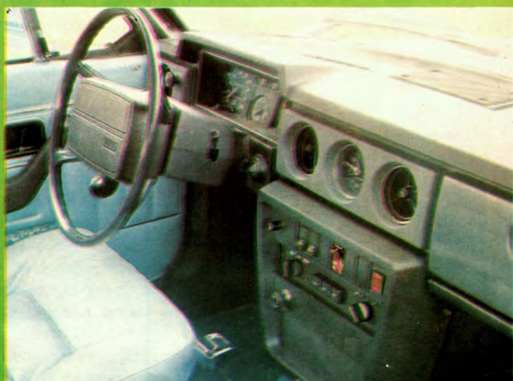
● Instrumentbrädan är helt ny. Hastighetsmätaren är rund och lättavläst, reglaget för vindrutetorkare och -spolare sitter på rattstängan.
