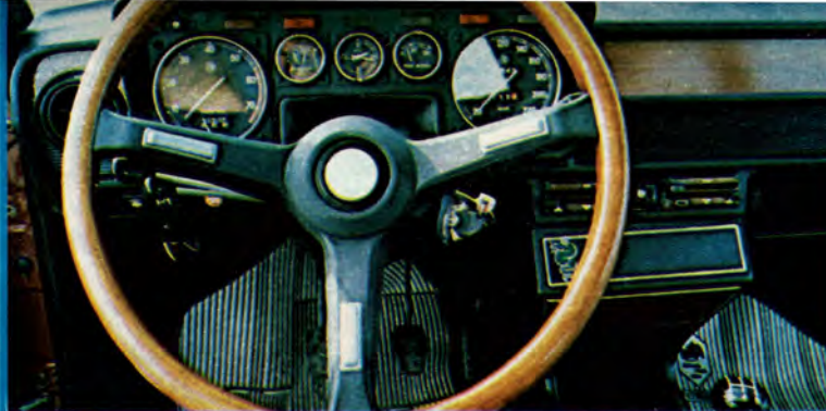
● Alfettan har ganska bra instrumentering även om hastighetsmätaren och varvräknaren hade varit lättare att läsa av om de hade flyttats in närmare rattaxeln.
