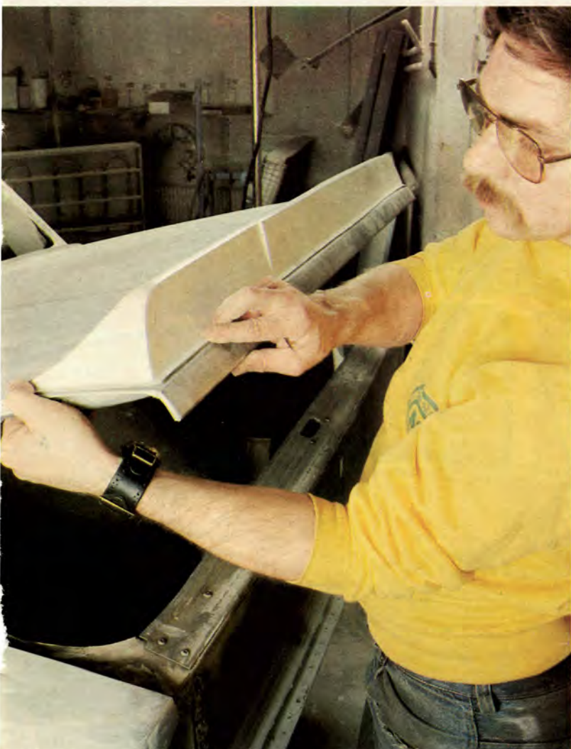
● Kjell Emilsson passar in "ankstjärten", dvs den bakre spoilern. Den fästs underifrån med fyra plåtskruvar, och monteringen medförde inga problem.
