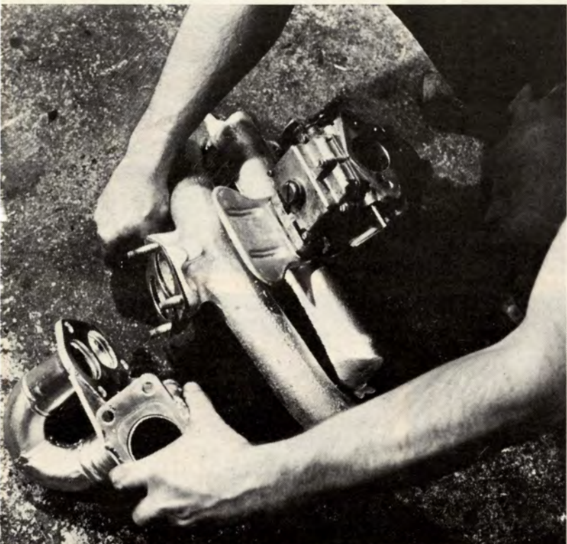
1. Monteringen av turbon börjar med att avgasröret till turbinen skruvas fast vid grenrörsflänsen. Det passar perfekt, det är bara att lägga dit packningen, passa in hålen i pinnbultarna och dra åt tre muttrar. Tar 10 minuter.
