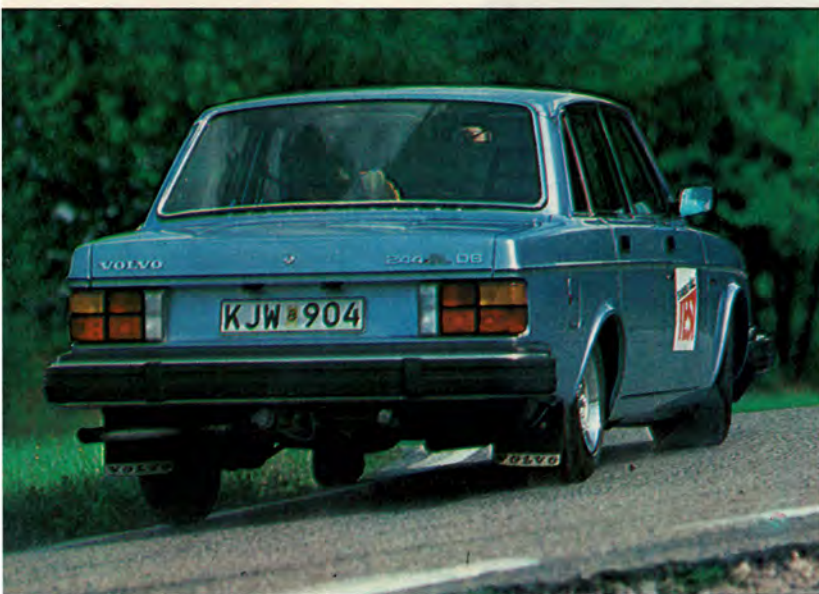
● Dieselversionen är mera framtung än en vanlig Volvo och kränger därför mera när den pressas genom en kurva.
