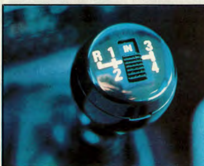
● GL har överväxel med strömbrytare i växelspaksknoppen.
