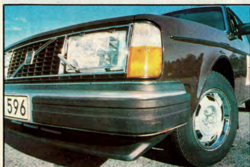
● Volvo GL: spoiler, bredare fälgar med kromringar, bredare strålkastare.
