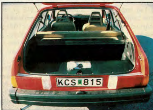
● Denna 343:a är avsedd för gasdrift med en extra tank längst bak i bagageutrymmet.
