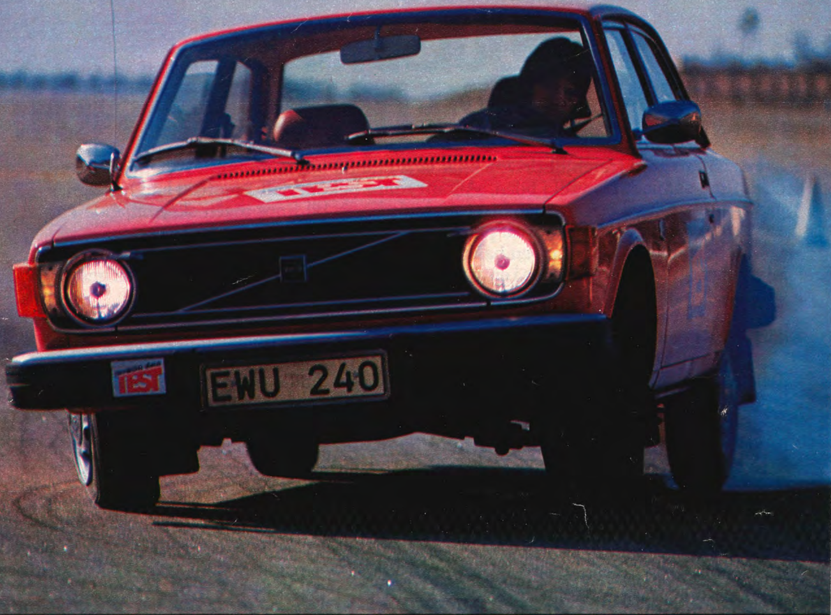
● Cirkelkörning med standarddäck. Bilen kränger, höger framdäck viker sig nästan och inre bakhjulet spinner loss.
