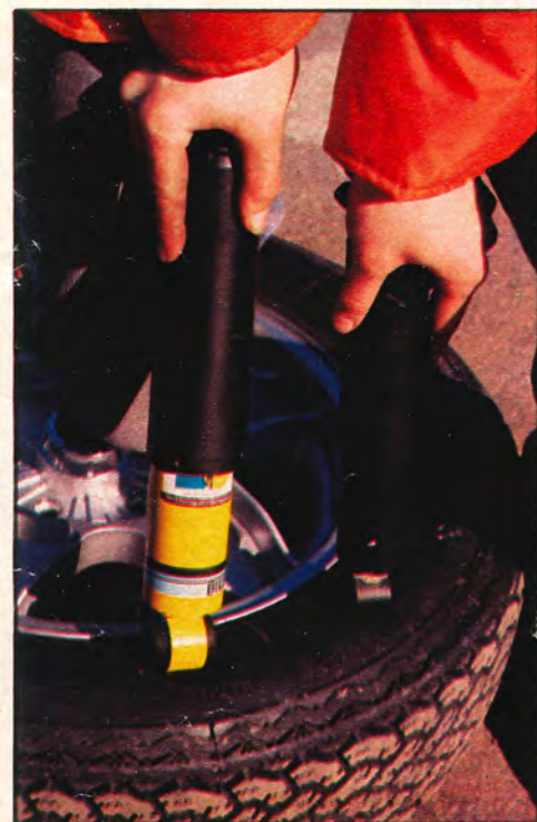
● Så mycket kraftigare är gastryckdämparen (den gula). På Volvo monteras stötdämparen inne i spiralfjädrarna (t h)
