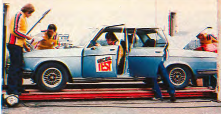
● BMW: fullproppat under huven, men välplanerat. Åtkomligheten försämrats av att motorn lutar. BMW kräver expertjobb.
