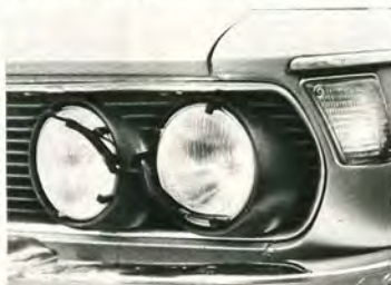
● Dubbla lyktor med små ljusöppningar, dubbla torkare. Dyrt och krångligt att underhålla. Som här på BMW.
