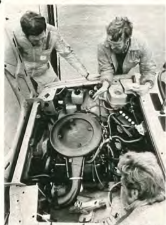
● Motorrummet i Renault 30: gott om svängrum för arbete. Skärmarna är lätta att byta.
