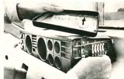
● Rover har tänkt till: enkelt och förnuftigt uppbyggd, lättjobbad. Här säkringarna.
