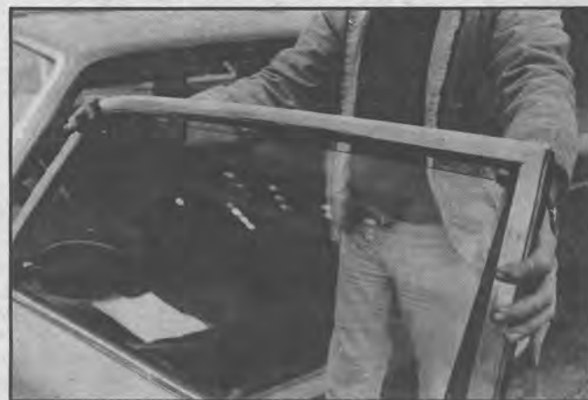
Kontrollera att fönsterhissarna drar upp fönstret rakt i ramen. Kan ibland gå sönder.
