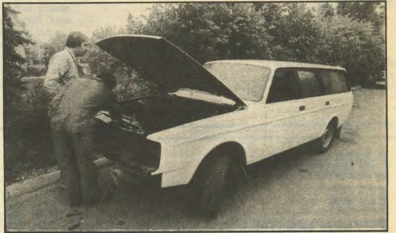
Här – i motorutrymmet som gapar så tomt – ska underverket ske. Turbotillsatsen för nära 7 000 kr ska göra 100-hästaren till en 140-hästare. Kommer grejerna att hålla? Kan bränsleförbrukningen bli lägre?
