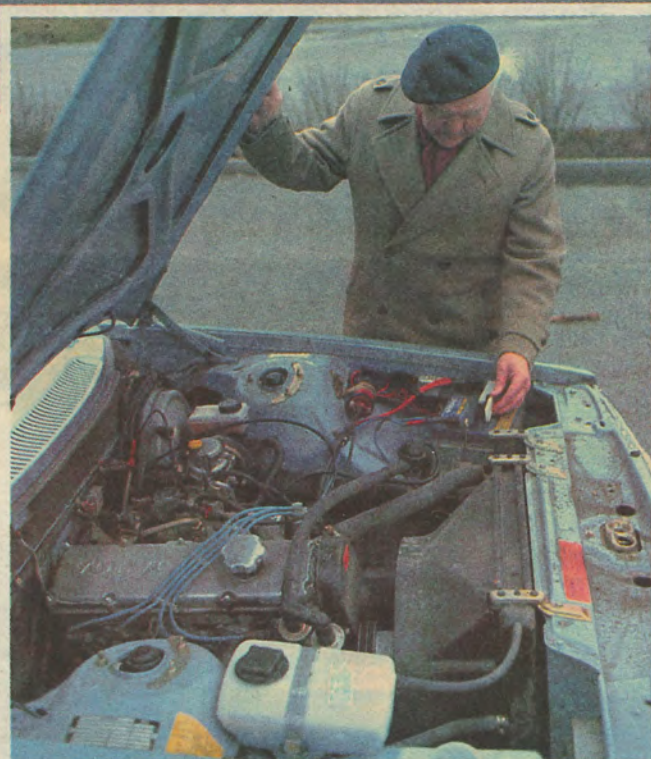
B 23-motorn har utmärkt segdragning, vilket ger smidig lågfartskörning. Just i dagarna inför Volvo en femte växel, som ersätter den elektriska överväxeln.
