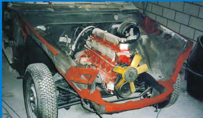
De voorkant van de carrosserie is geheel geschroefd, handig bij restauratiewerkzaamheden.
