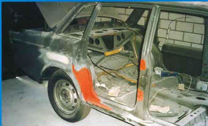
Aan de carrosserie zat weinig roest, wat echter niet uitsluit dat u het bij een andere 164 aanzienlijk slechter kunt treffen.
